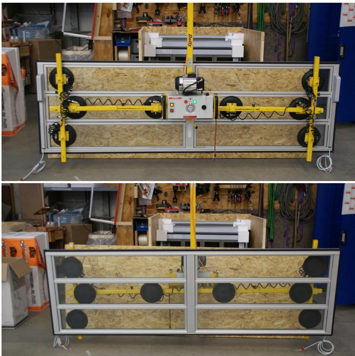
Abb. 6 Transport mit Saugeinrichtungen
