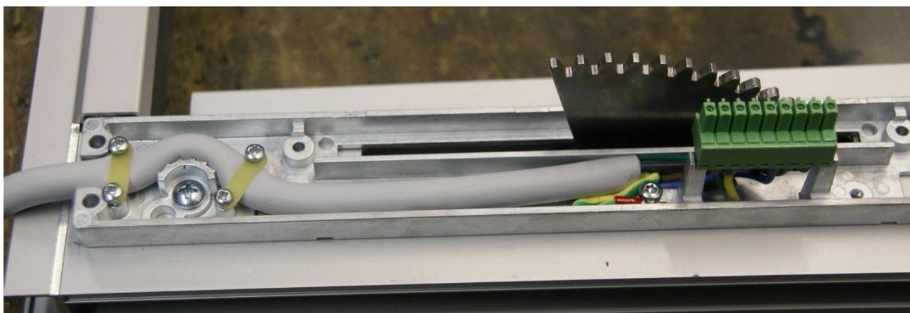
Abb. 38 LAH 65 K 230 V mit der Kabelführung von unten
