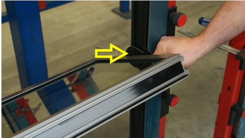
Abb. 30 Montagehilfe entfernen
