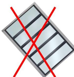
Liegend verpackte Lamellenfenster erst ausklappen und dann über die kurze Kante aufrichten!
