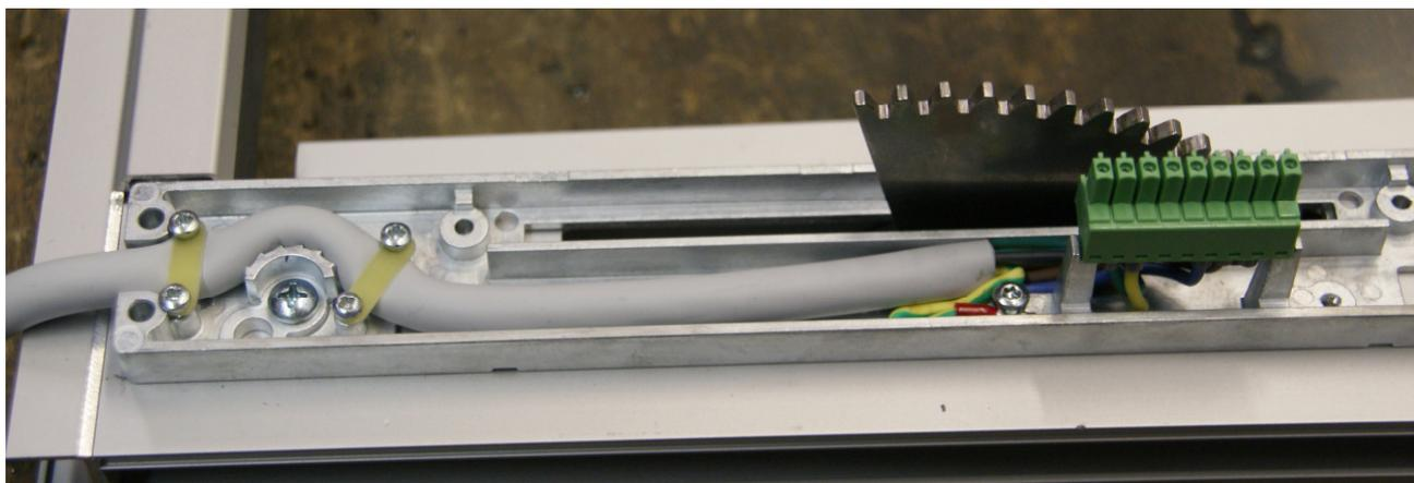
Zum Montieren des Motors muss das Fenster geschlossen sein. Der Motor wird fest auf die bereits montierte Motorkonsole aufgedrückt und mittels der Torxschrauben wieder befestigt.
